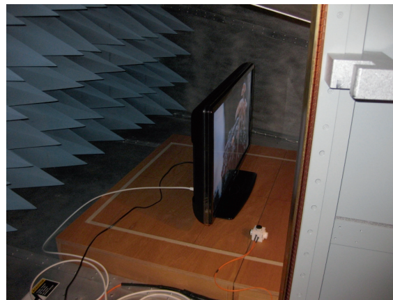
Figuur 4 en 5. Sensor bij settop box en televisietoestel in GTEM
