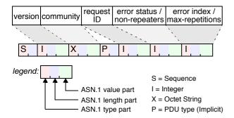
Fig. 2. SNMP header - BER encoding
