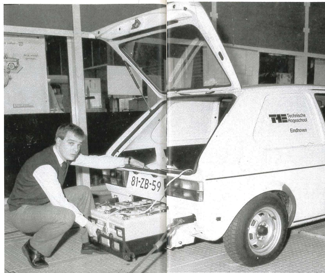
De accu's zijn geplaatst op een slede, waardoor onderhoud en controle op eenvoudige wijze kunnen geschieden.
