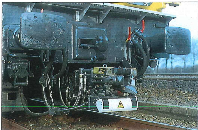
Automatische koppeling aan cabinezijde 2. Linker afbeelding: situering stoot- en trekwerk; rechter afbeelding: de elektrische contacten die zich in tegenstelling tot die van het stroomlijnmaterieel aan de onderzijde van de automatische koppeling bevinden. Egbert van Werkhoven
