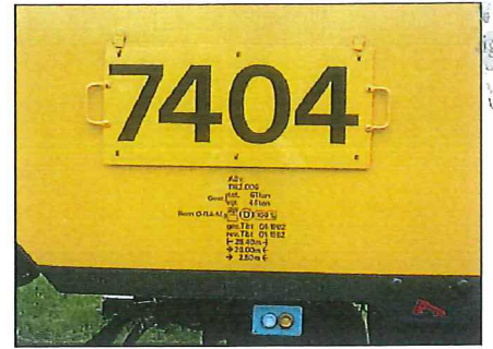
Het treinstamnummer wordt bepaald door de lengte van de stam (vier rijtuigen = 7400-serie) en het koprijtuig (het volgnummer hiervan geldt voor de hele treinstam Bvk 270 7004). Egbert van Werkhoven
