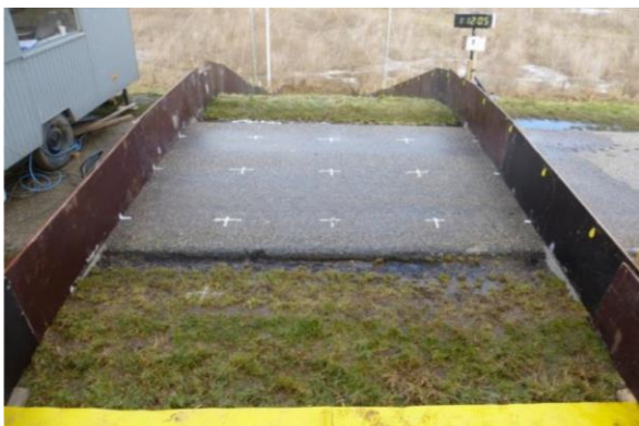
Afbeelding 5. Testsectie van een dijk met een weg op de kruin in Millingen aan de Rijn [7]
