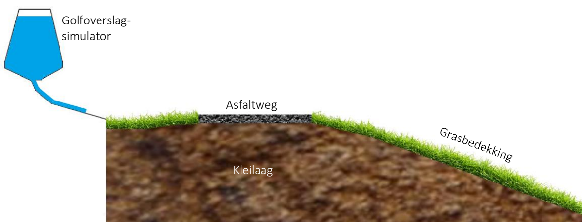
Afbeelding 3. Schets van het model gebaseerd op de dijkegeometrie zoals gemeten tijdens het golfoverslagexperiment in Millingen aan de Rijn
