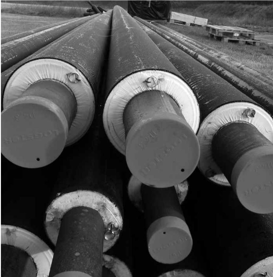
Geïsoleerde pijpen voor ondergrondse warmtenetten (foto: Mike1024)
