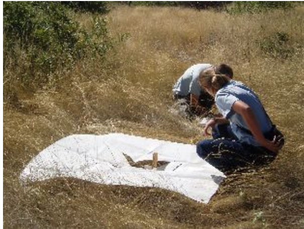
DIANAS UTILIZADAS PARA LA CORRECCIÓN GEOMÉTRICA DE LAS IMÁGENES
