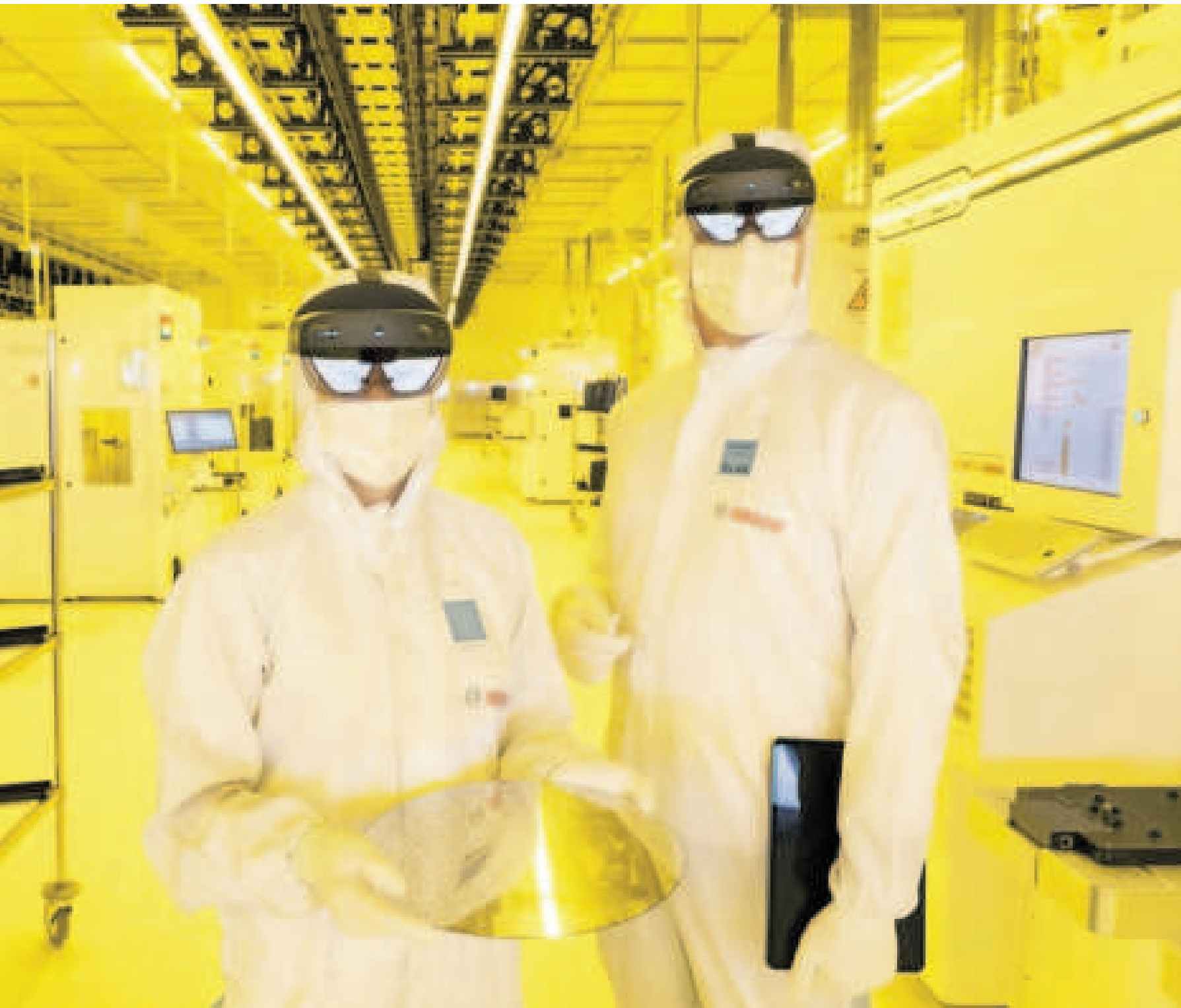
Medewerkers van de Bosch-fabriek in Dresden waar chips worden gefabriceerd, vooral voor de auto-industrie. De chips worden gemaakt op een plaat van 1 millimeter dikte, het hele productieproces duurt zes weken.
