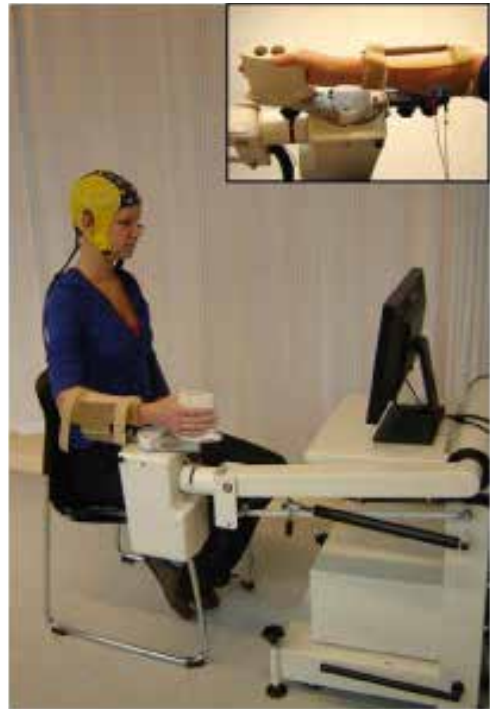
Figuur 7: Opstelling op de Universiteit Twente waarmee we hersengolven (EEG) meten die opgewekt worden door mechanische verstoringen van de pols. Hiermee proberen we te bepalen hoe goed de sensorische informatie van de spieren naar de cortex overgedragen wordt via de sensorische zenuwbanen die door het ruggenmerg lopen (zie figuur 1).
