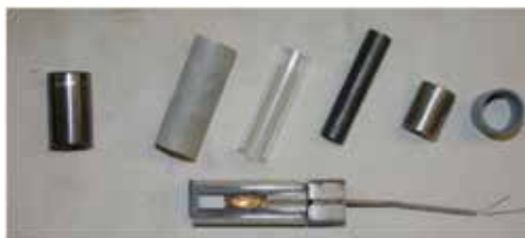
Figuur 2. Onderdelen voor een hoge druk experiment in een piston cylinder pers: Van links naar rechts wolframcarbide piston, talkcilinder, pyrex cilinder, grafietoven, stalen plug met kleiring. In het midden een doorsnede waarin een gouden capsule (die het gesteentemonster isoleert van zijn omgeving) en twee metalen draden van een thermometer zichtbaar zijn. De lengte van de talkcilinder is ongeveer 3 cm, met een diameter van 1,3 cm. Foto: W van Westrenen
