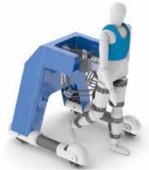
Figuur 4: Impressie van het ontwerp van de mobiele LOPES. Deze robot ondersteunt het lopen zonder gebruik te maken van een lopende band.
