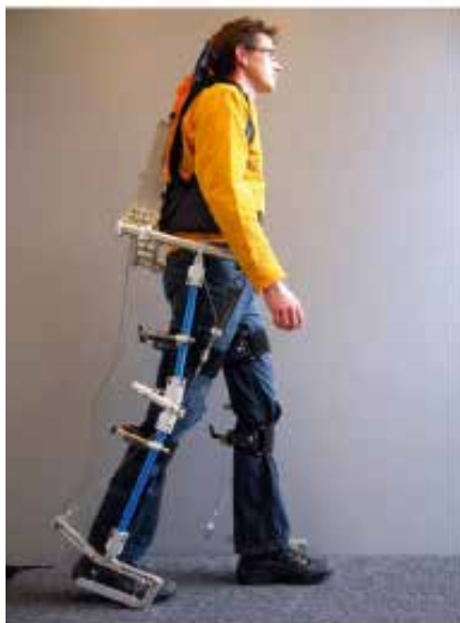
Figuur 9: Een eerste versie van de XPED. De Universiteit Twente en Technische Universiteit Delft zijn een exoskelet aan het ontwikkelen dat het lopen makkelijker maakt. Ons onderzoek richt zich erop om hulpmiddelen voor medewerkers in de fabriek te ontwikkelen. De bedoeling is dat wij de mens extra robot-handen en -armen geven, waarmee zij hun werk net zo intuïtief en snel kunnen doen als zouden zij hun eigen handen gebruiken. Dit echter zonder dat het bewegingsapparaat de volle last hoeft te dragen.
