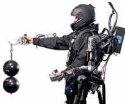
Figuur 10: Een exoskelet ontwikkeld door SARCOS (VS). Het maakt mensen sterker en ontlast het spier-skelet systeem bij het tillen en manipuleren van zware objecten. De Universiteit Twente en Technische Universiteit Delft werken samen aan een generatie van exoskeletten die menselijke handelingen ondersteunt zonder daarbij de mens te beperken en de mens volledig in controle laat.
