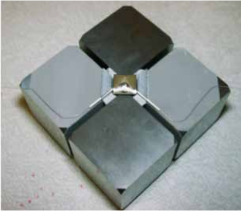
Figuur 4. (a) Een gevulde octaëder (Figuur 3) ligt in de holte die ontstaat tussen vier wolframcarbide kubussen, waarvan kleine hoekjes zijn afgeslepen. De grijze plakjes die het octaëder omgeven zijn gemaakt van klei en dienen om het octaëder op zijn plaats te houden. De twee metalen draden vormen een thermometer. Foto: W van Westrenen.
