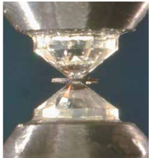
Figuur 5. Zijaanzicht van het hart van een diamantpers (Foto: Sebastien Merkel, Universiteit Lille). Twee fijngeslepen diamanten (hoogte 4 mm per diamant) zijn met hun brede basis op metalen houders gelijmd, zodat hun smalle vlakgeslepen toppen naar elkaar toe wijzen. Tussen de vlakgeslepen toppen is een plakje rhenium metaal geklemd. In een gat midden in het rhenium kan een gesteentemonster worden geplaatst. Door de metalen houders naar elkaar toe te drukken wordt de druk tussen de diamantpunten hoger dan de druk in het midden van de Aarde.
