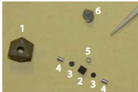
Figuur 3. De onderdelen van een typisch multi-anvil experiment, met rechtsboven het uiteinde van een tandenstoker als schaal. In het centrale gat van een keramisch octaëder (1) worden een kleine cilindrische oven (2) met twee dekseltjes (3) geplaatst. De oven wordt afgesloten door twee metalen pluggen (4) die elektrische stroom geleiden. In de oven komt een kleine keramische huls (5), waarin een gesteentemonster wordt geplaatst. De typische grootte van een octaëder na samenpersen tot een druk van 250.000 atmosfeer is bovenaan weergegeven (6). Foto: W van Westrenen.
