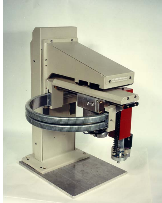
Figuur 2 Links: De SIRE T3, een van de eerste wafersteppers, ontworpen begin jaren 80 bij het Philips Nat.Lab: 1.5 \mu\text{m} applicatie, 6" wafers, 20 wafers/uur. Rechts: de mini variant van het Philips CFT Variabel Robot Systeem (VRS). Ontworpen begin jaren 80 en nog steeds (!) in gebruik. Nauwkeurigheid ca. 0,02 mm, maximale versnelling 10 \text{m/s}^2 , maximale snelheid 1m/s.
