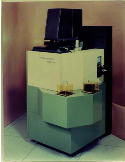
Figuur 2 Links: De SIRE T3, een van de eerste wafersteppers, ontworpen begin jaren 80 bij het Philips Nat.Lab: 1.5 \mu\text{m} applicatie, 6" wafers, 20 wafers/uur. Rechts: de mini variant van het Philips CFT Variabel Robot Systeem (VRS). Ontworpen begin jaren 80 en nog steeds (!) in gebruik. Nauwkeurigheid ca. 0,02 mm, maximale versnelling 10 \text{m/s}^2 , maximale snelheid 1m/s.
