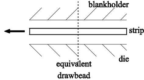
FIGURE 8. SIMPLE STRIP TEST
