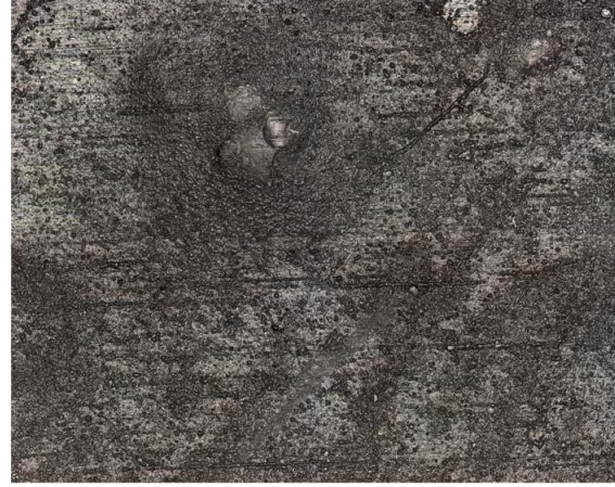
(d) Devulcanized material, amplification 50*; surface 2*2 mm 2 .
