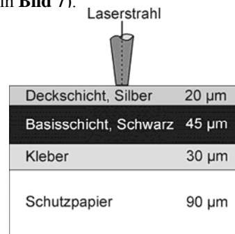
Bild 7 Schichtaufbau "3M Laserbeschriftbare Folie"
