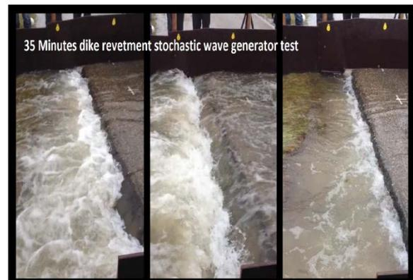
**Fig. 3** Wave generator experiment, Millingen aan de Rijn–Nijmegen
