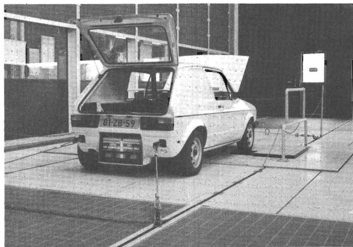
De THE-elektromobiel op de rollenproefbank in het Vervoerslaboratorium bij de afd. W
