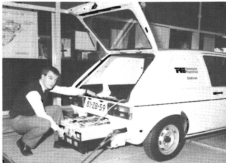
Leo van Dongen en het loodzware probleem van de elektrische auto: het accupakket van totaal 20 batterijen (weegt ca. 600 kg).
