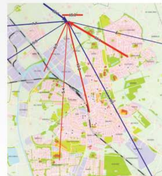
Figuur 2: Voorbeeld vervoersspanning. Rode pijlen zijn intern, blauwe pijlen extern. Bron: bewerking Mabi Surround resultaten
