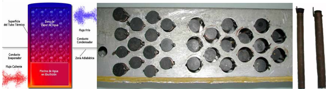
Fig.2 a) Ciclo termodinámico en tubo, b) Vista superior de arreglos de tubos, c) Tubos de 16 mm y 19 mm
